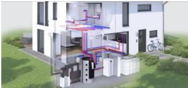
System funkcjonowania centrali rekuperacyjnej CWL-Excellent firmy Wolf fot. Wolf
